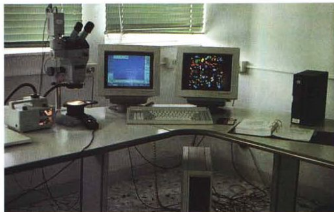
Il sistema VIDAS di acquisizione, elaborazione ed analisi dell'immagine della Zeiss - Kontron è utilizzato prevalentemente per la misura delle impronte delle gocce su cartine idrosensibili nello studio della qualità della distribuzione di macchine per i trattamenti fitofarmaceutici.
